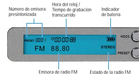
Hay otros dos modos en el modo FM, el modo Presintonía FM y Sintonización FM. En el modo Presintonía FM, puede seleccionar una emisora FM presintonizada. En el modo Sintonización FM, puede asignar una presintonía a una emisora FM. Véase "Utilización de Dell DJ Sintonizador FM en línea" para más información.
