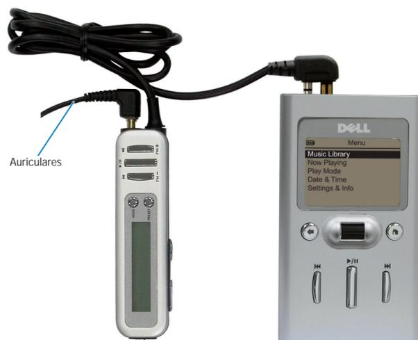
Conecte SÓLO el Sintonizador FM en línea (pieza número F7492) o el mando alámbrico a distancia (pieza número F7495) al reproductor Dell DJ. La conexión de otros Sintonizadores FM en línea o mandos alámbricos a distancia al reproductor Dell DJ pueden producir daños permanentes.
